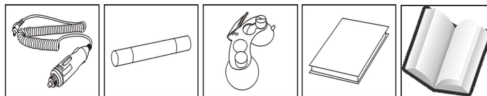
Кабель питания с адаптером Запасной предохранитель Кронштейн крепления с вакуумными присосками Велкро застёжка (липучка) Руководство пользователя
